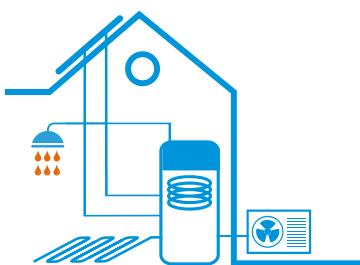
Podna jedinica sa integriranim ECH<sub>2</sub>O toplinskim spremnikom
